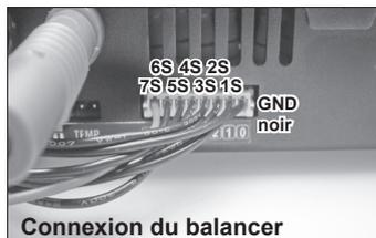
**ATTENTION:** Le fil noir de la prise Balancer (-) doit toujours être sur le PIN0 (GND), quel que soit le nombre d'éléments qui composent l'accu et le nombre de fils que compte la prise Balancer.
