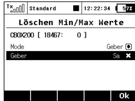
Hier im Beispiel: Der *Sa* Schalter wurde zur Löschung der Minimum/Maximum Werte der Central Box200 ausgewählt. Für die Löschung wird einfach der gewählte Schalter betätigt.
