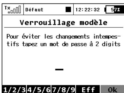
Ici, saisissez le code à deux chiffres en utilisant les touches **F(1)** "1/2/3", **F(2)** "4/5/6" et **F(3)** "7/8/9". Ce code apparaît sur l'écran et sera par la suite utilisé pour déverrouiller l'émetteur. Un appui sur **F(4)** Effacer vous permet de supprimer le nombre spécifié et vous pouvez recommencer.
