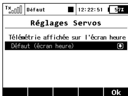
Après avoir appuyé sur la touche F(1) lorsque Servo balancer est en surbrillance, le sélecteur de vitesse est affichée. C'est ici que vous pouvez sélectionner un paramètre de télémétrie, qui apparaîtra à la place de l'emplacement de l'horloge numérique sur la barre supérieure de l'écran. De cette façon, vous pouvez sélectionner, par exemple, l'affichage de la consommation de courant instantanée des accus, ce qui est très utile lors de l'équilibrage des différentes courses des servos.
