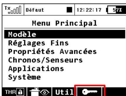
Si vous prêtez l'émetteur à une autre personne et vous voulez vous assurer qu'aucun changement de la configuration du modèle qui pourrait influencer sur le fonctionnement de l'émetteur ou le modèle ne puisse être fait, vous pouvez profiter de la fonction de **verrouillage du modèle**. Dans le Menu principal, appuyez sur la touche **F(4)** pour afficher la boîte de dialogue pour la saisie du mot de passe unique.
