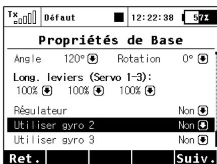
Maintenant, il est possible d'avoir jusqu'à trois fonctions indépendantes pour contrôler le gain du gyroscope. Par défaut, le gyroscope n° 1 est toujours actif. Les autres sont activés dans le menu *Modèle* → *Propriétés de Base* ainsi que la fonction *Régulateur*.
