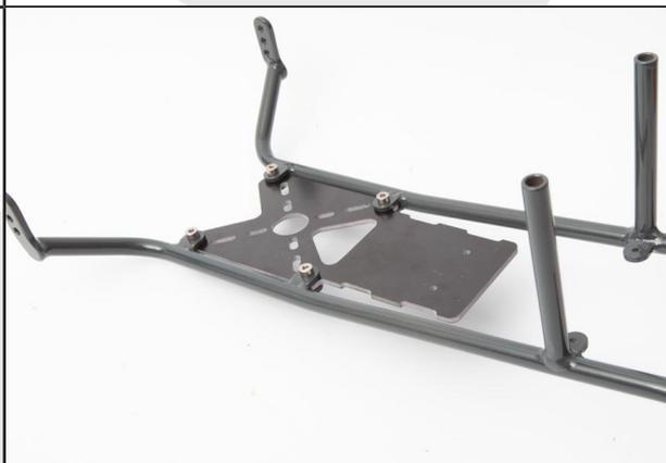
Montez la 2e platine à l'aide de 2 vis CHC 3-10, rondelle M3 et écrous freins M3. Attention cette platine doit être derrière la patte de fixation.
