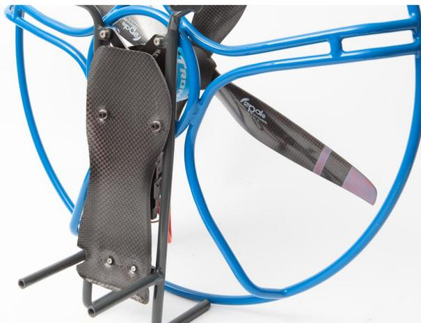
Retirez au préalable les deux vis M4 inférieures tenant l'arceau du châssis.
