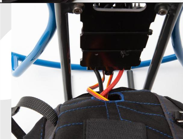
Passez derrière le châssis la sangle de fixation de la sellette et l'insérer dans la boucle située à l'opposé.
