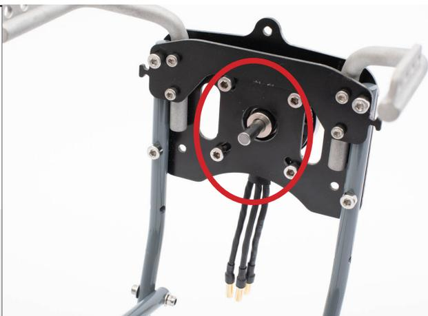
Fixez ensuite l'arceau au chassis à l'aide de 3x CHC M4-8 et écrous freins M4.
