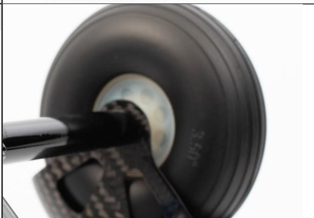
Fixez les deux barres latérales sur l'axe arrière à l'aide de 4 vis CHC M3-25, 4x écrous freins M3 et 8x rondelles M3.
