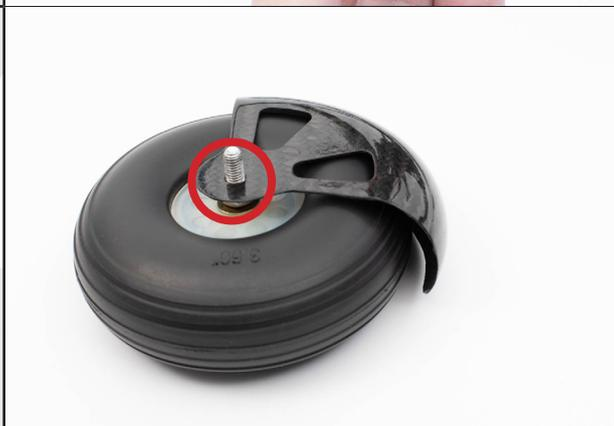
Fixez celui ci contre le tube du train, en serrant celui ci avec l'écrous M5 montez auparavant. ( tout en laissant la roue libre de rotation)
