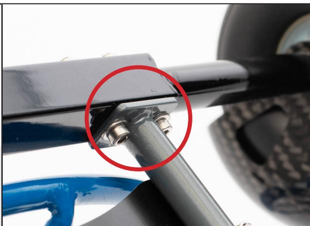
Fixez la potence aux barres latérales à l'aide de 2x vis CHC M3-30, 4x rondelles M3 et 2x écrous freins.
