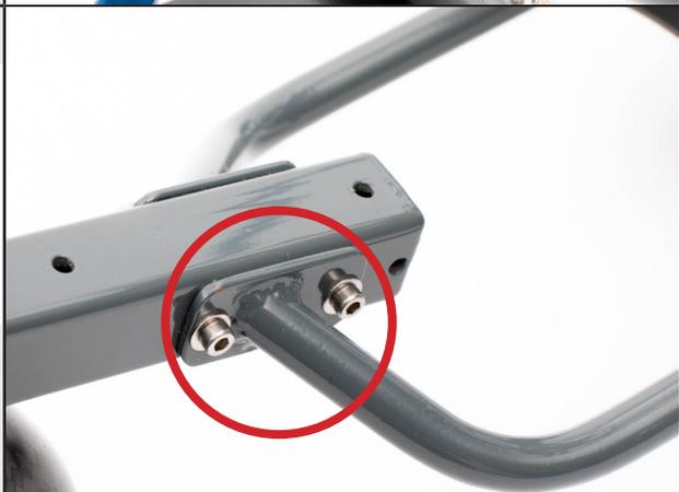
Fixez la fourche avant, à l'aide d'une vis CHC M4-30, 2x rondelles M4 et écrous freins M4. Vous pouvez optionnellement, installer le garde boue avant en carbone.
