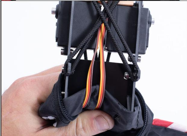
Insérer le câble du variateur de vitesse à travers la combinaison du pilote ( il est préférable d'y mettre aussi le récepteur)
