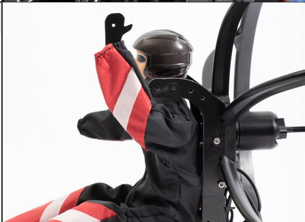
Le dos du pilote est conçu pour accueillir une batterie de 3 à 4S 2000 à 2500mAh.
