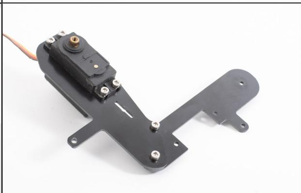
Monter la partie dorsale avec une vis M3-8 et écrous freins M3
