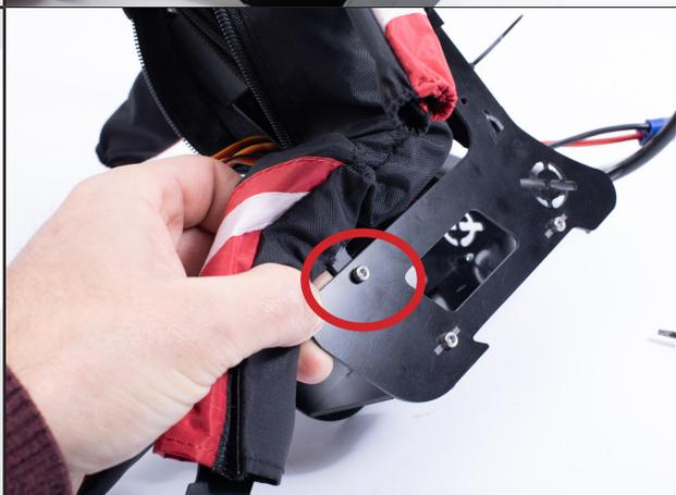
le dos du pilote se fixe à l'aide de vis CHC M3-10 et écrous freins.
