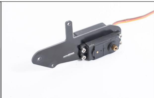
L'assemblage de la 2e partie du flanc s'effectue avec 2 vis CHC 3-8 et écrous freins M3
