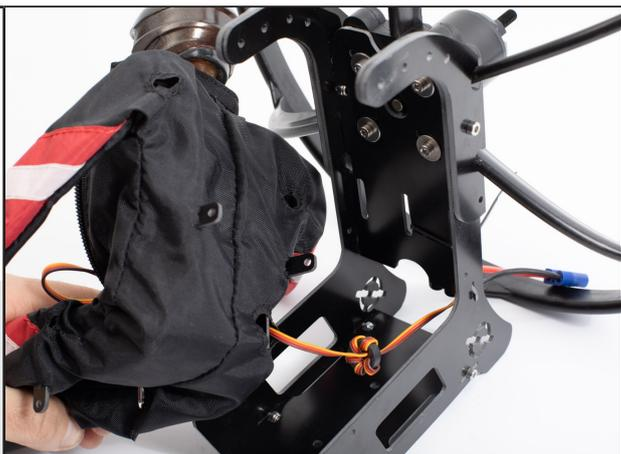
Fixer les jambes du pilote aux chassis à l'aide de 2 vis CHC M3-8 et écrous freins M3
