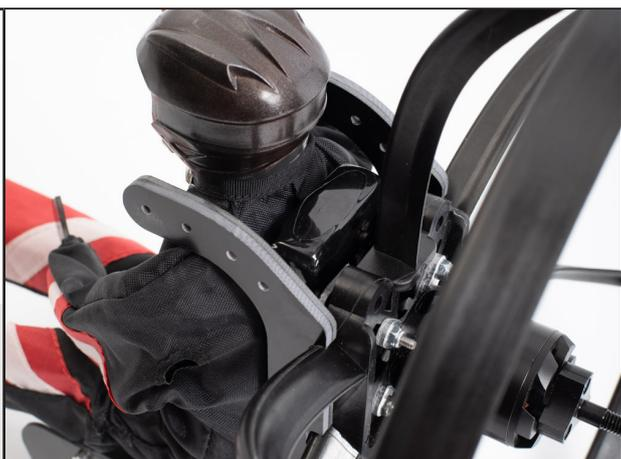
Le point d'équilibre du châssis doit se trouver au niveau du point d'ancrage. Sur ce point, le châssis doit se maintenir, en état de marche (prêt à voler), à l'horizontal.
