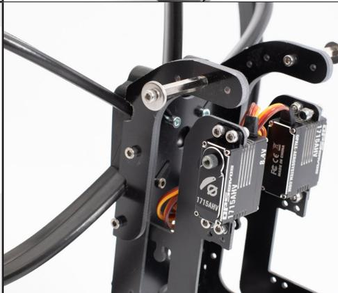
Afin d'optimiser le volume, la masse, la réactivité de l'ensemble, le kit support de servo est conçu pour accueillir les servomoteurs OPS1715AHV, aussi bien pour les bras, que pour la partie accélérateur. Ils sont à monter sur les flancs à l'aide de vis CHC M3-8 et écrous freins correspondants.
