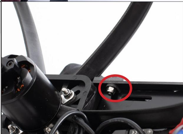
Procéder ensuite à la fixation des bras sur le palonnier du servomoteur, à l'aide de 2 vis philips 2x8. Une fois le palonnier en place, le placer dans la combinaison.
