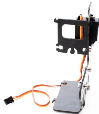
Maintenant assemblez l'autre flanc monté par symétrie et utilisez les CHC M3x8 et écrous freins pour le montage.
