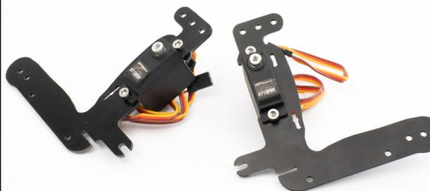
Montez la partie inférieure, également avec 2x CHC 3x8 et écrous freins.
