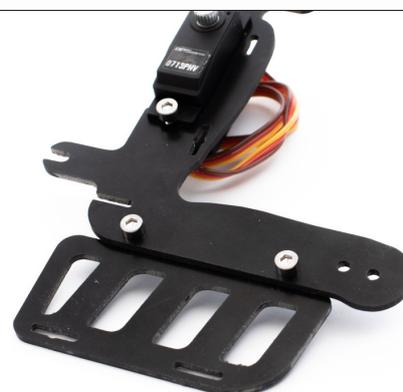
La platine basse est à monter avec une CHC 3x8 et écrou frein.
