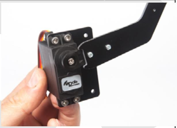
Positionner l'ensemble comme sur la photo ci-contre et fixez l'ensemble à l'aide de vis CHC M3-20 , avec rondelles et écrous freins.
