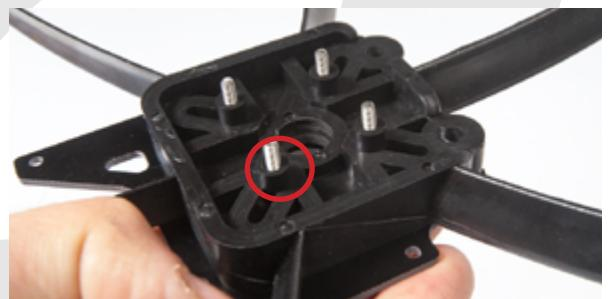
Montez la croix de fixation sur le moteur et ensuite fixez le moteur sur les 4 vis . Serrer le tout avec 4 écrous freins M3.
