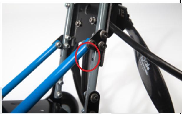
Insérez ensuite la platine verticale du kit. Elle doit coulissier entre la platine horizontale et la pièce en forme de "X" présente à l'arrière du chassis
