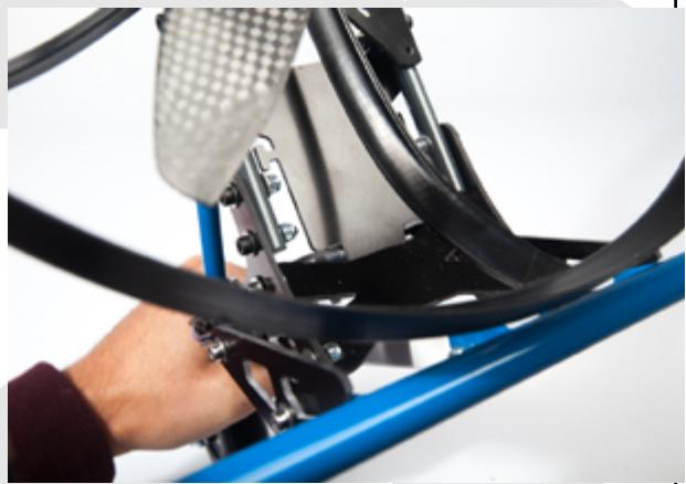
Dann die Platte mit den zuvor entfernten Schrauben CHC M3-16 festziehen
