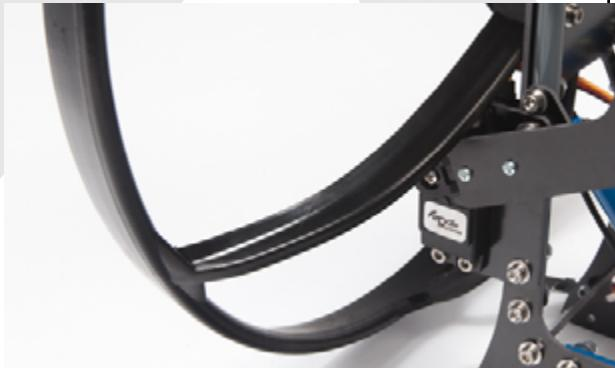
Mettre sous tension le servomoteur, ajuster la fin de course mécaniquement à l'aide de votre radiocommande pour avoir une position haute du palonnier comme sur la photo ci contre. Le manche de votre radio doit être en position haute.
