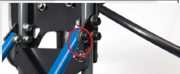
Utilisez les ergots prévus sur la platine verticale pour positionner l'élastique. Il va permettre de retenir la batterie de propulsion.
