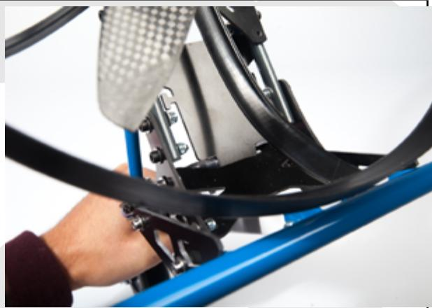
Fixez la platine avec la vis CHC M3-16 préalablement démontée.
