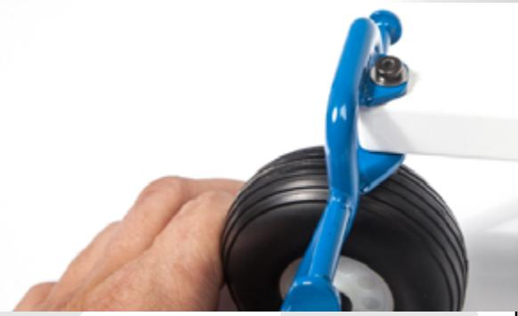
Befestigen Sie das Rad mit 1 x M4x40 Schraube. Platzieren Sie die M4-Mutter und schließen Sie sie fest genug, aber nicht zu stark, um die Raddrehung auf dem Rad zu erhalten. Setzen Sie dann das Ganze auf die Hinterachse und ziehen Sie die Mutter gegen die Hinterachse fest. Das Rad kann sich frei bewegen. Entsprechende Montage mit dem Rad der gegenüberliegenden Seite.
