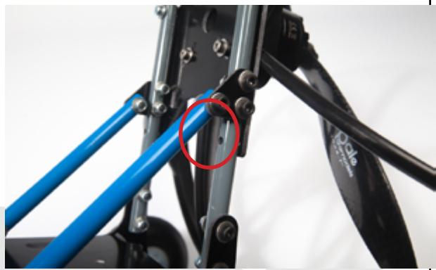
Setzen Sie die vertikale Platte des Kits ein. Diese muss zwischen der horizontalen Platte und der X-förmigen Platte auf der Rückseite des Rahmens gleiten
