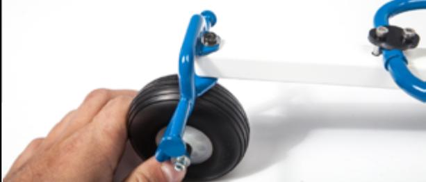
Fixer la roue à l'aide d'une vis CHC M4-40. Mettre en premier l'écrou frein M4, le serrer suffisamment sans empêcher la rotation de la roue sur la vis. Ensuite insérer l'ensemble sur l'essieu arrière et serrer l'écrou frein contre l'essieu. La roue doit conserver une rotation libre.
