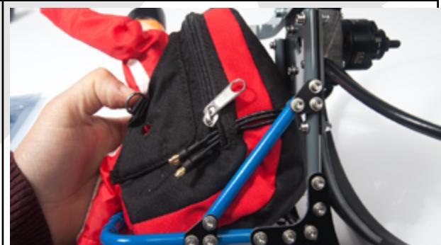
Verbinden Sie dann den Regler mit dem Motor. Achten Sie jedoch auf die Motordrehung. Wenn die Drehung umgekehrt werden soll, müssen Sie nur 2 Drähte von den 3 gewechselt werden (lesen Sie das ESC-Handbuch für weitere Details)
