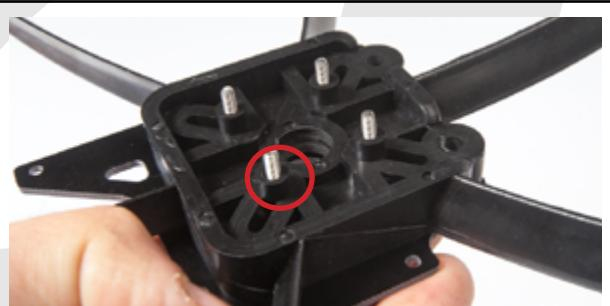
Montieren Sie den Motorhalter am Motor und setzen Sie den Motor auf die Schrauben und ziehen Sie den Motor mit 4 x M3 Muttern fest
