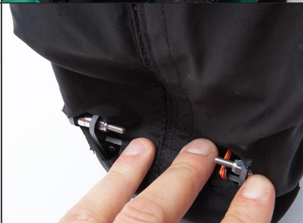
Positionnez le support moteur sur les deux vis
