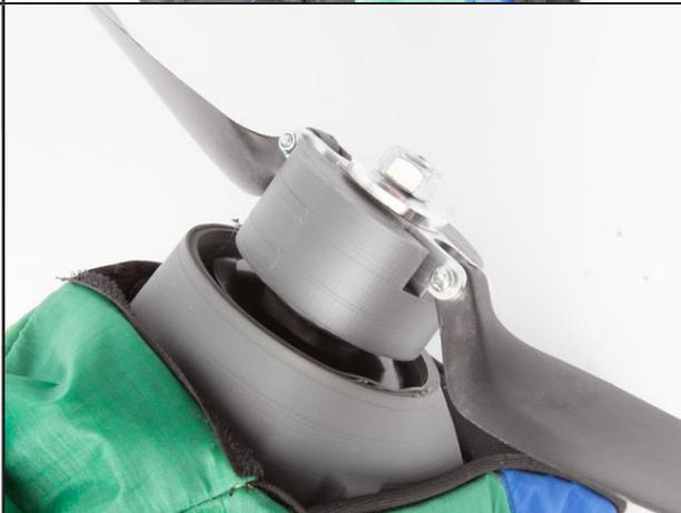
Passez l'hélice dans l'élastique et remontez le jusqu'au moyeu
