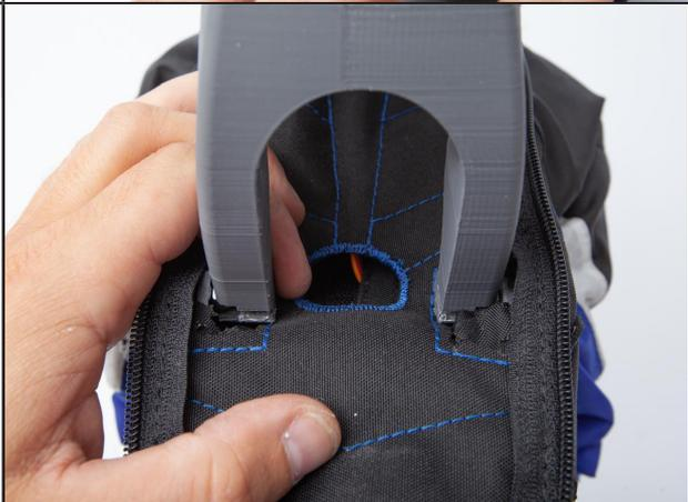
Passez les cables du variateur à travers la sellette et entre le velcro de la combinaison du pilote
