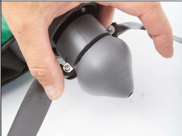
Fixer le cône en utilisant une CHC M3-10
