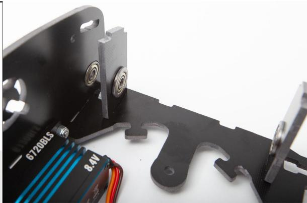
Positionnez la platine frontale sur les deux pieces comportant les roulements intérieurs puis fixez la sur le flanc à l'aide d'une vis CHC 4x12 et écrou frein M4.
