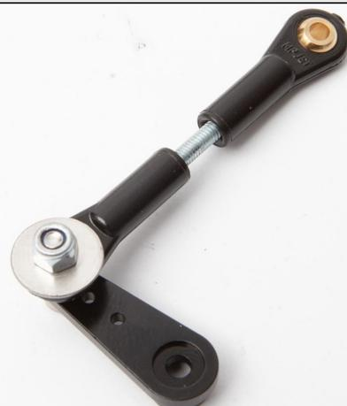
Montez l'autre partie de la bielle sur le bras du pilote. Choisissez le trou le plus proche de l'axe de rotation. Les autres trous peuvent être utilisés si le palonnier du servomoteur est plus long que celui d'origine, ou si le montage Servomoteur / Bras ne permet pas d'avoir une amplitude du servomoteur de 90°.
