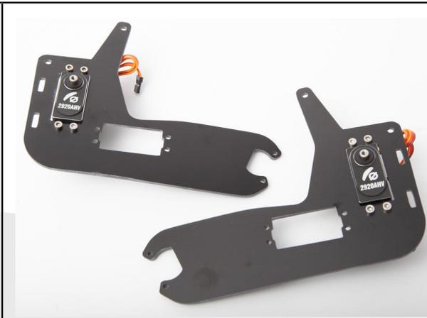
Montage de la platine dorsale inférieur à l'aide de 2x vis CHC M3x8 et écrous freins.
