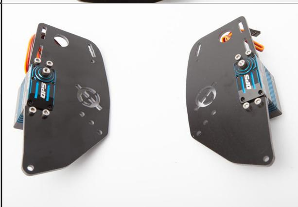
Montez sur chacune de ces pièces, un roulement en symétrie (le vérifier grâce à l'épaulement présent sur le roulement).
