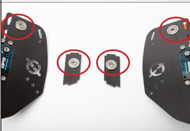
Montez la platine dorsane. La fixer à l'aide d'une vis CHC M4x12 et écrou frein M4
