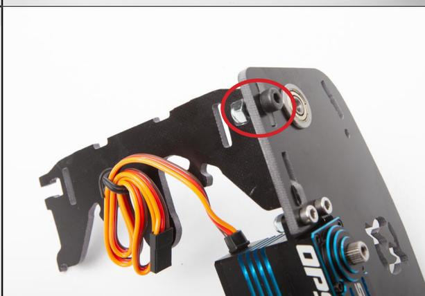
Positionnez les supports de roulement. Les roulements doivent être en opposition avec les flancs ( à vérifier avec l'épaulement du roulement)
