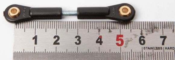
Montez la bielle sur le palonnier du servomoteur à l'aide d'une CHC M3x12, rondelle large M3 et écrou frein M3. Soyez bien vigilant au sens du montage, il doit être impérativement comme sur la photo. Dans le bras contraire, il y aura une collision mécanique lors de l'utilisation du bras.
