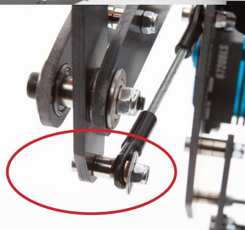
Percez le dernier trou du palonnier en aluminium fourni avec les servomoteurs OPS4820BLS / OPS-6720BLS à l'aide d'un foret 3mm.
