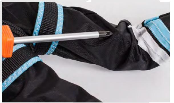
Insérer un élastique nylon dans la boucle prévue sur le volet arrière du harnais comme sur la photo ci-contre.
