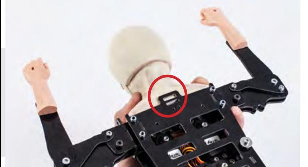
Schneiden Sie dann mit dem Schleifer das Harz und den Schaum des Kopfes des Piloten.
