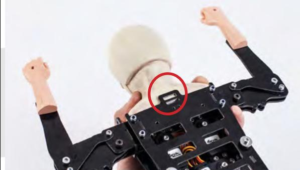
Découpez à l'aide d'une disqueuse la résine ainsi que la mousse de la tête du pilote.
