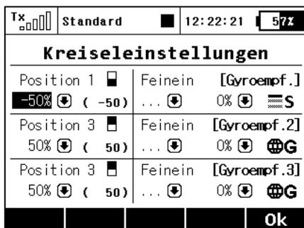
Im Kreiseleinstellungsmenü können die bis zu 3 Empfindlichkeiten (z.B. für drei Achsen) unterschiedlich und auch separat für jeden Flugzustand eingestellt werden.
