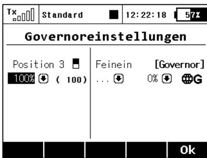
Sie können bis zu drei Drehzahlvorgaben im Menü *Governoreinstellungen* auswählen (0% bedeutet Motor AUS, 100% bedeutet Vollgas). Hier kann auch unter „*Feineinstellung*“ (Feinein.) ein eventuell gewünschter Trimmgeber ausgewählt und dessen prozentualer Bereich der Trimmmöglichkeit programmiert werden. Diese Werte können global für alle Flugphasen oder separat eingestellt werden.
