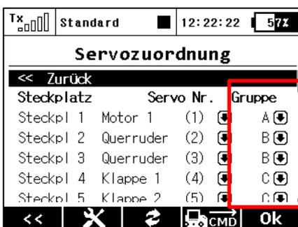
**Empfehlung:** Wenn Sie mehrere mechanisch gekoppelte Servos auf einem Ruder einsetzen, sollten auf die Servosignale dieser Servos gleichzeitig übertragen werden. Dazu können Sie in den Empfängereinstellungen (Geräteübersicht) die entsprechenden Servos in eine der Übertragungsgruppen (*Group A-C*) einsetzen. Dadurch laufen die Servos auf diesem Ruder synchron.
